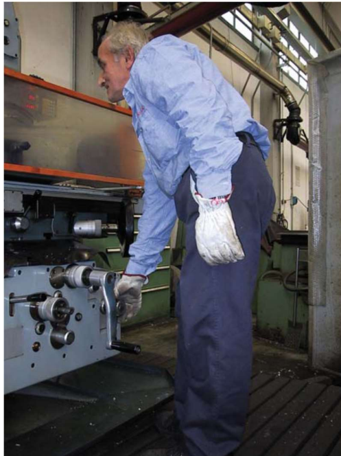
Figura 15 – Inserimento della frizione per la messa in rotazione del mandrino
