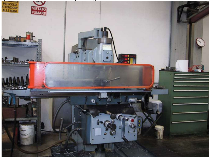
Figura 13 – Fresatrice dotata di riparo mobile con dispositivo di blocco
