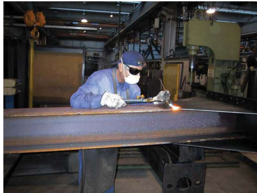
Figura 25 – Saldatura ossiacetilenica con materiale di apporto
