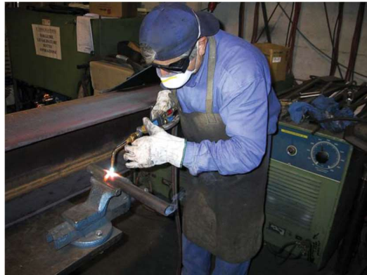
Figura 24 – Saldatura ossiacetilenica senza materiali di apporto
