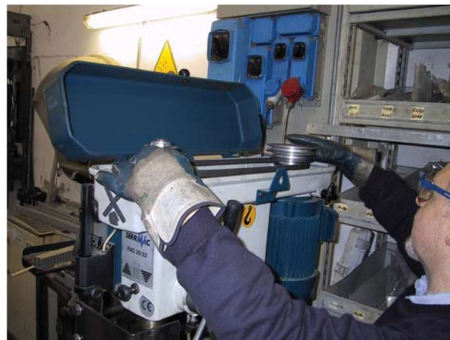
Figura 7 – Cambio della velocità di rotazione del mandrino
