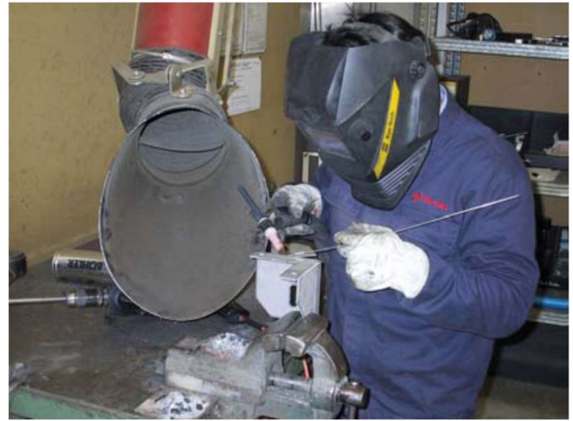
Figura 19 – Postazione di saldatura (con uso di materiale d'apporto) con bocca di aspirazione
