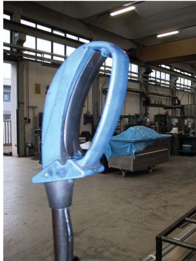
Figura 11 – Interruttore a pressione continua posto sull'impugnatura
