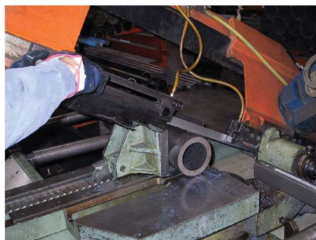
Figura 27 – Regolazione del carter copri-nastro
