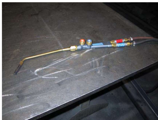
Figura 23 – Cannello da saldatura con i rubinetti di acetilene (rosso) e di ossigeno (blu)
