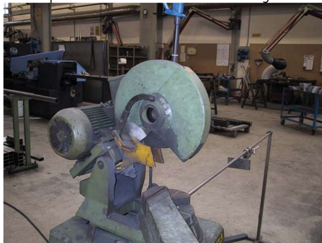
Figura 10 – Troncatrice con carter mobile a leveraggi
