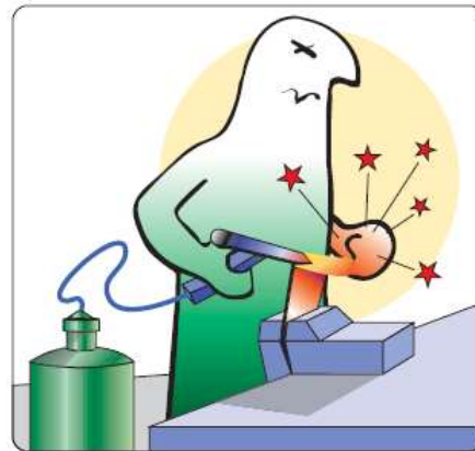
Ustioni per ritorno di fiamma al cannello, dovuto a ostruzione e/o contatto con le parti fuse.
