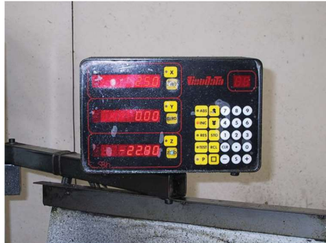
Figura 16 – Quadro di comando della fresatrice (notare i comandi per il moto del pezzo nelle tre direzioni X, Y e Z)
